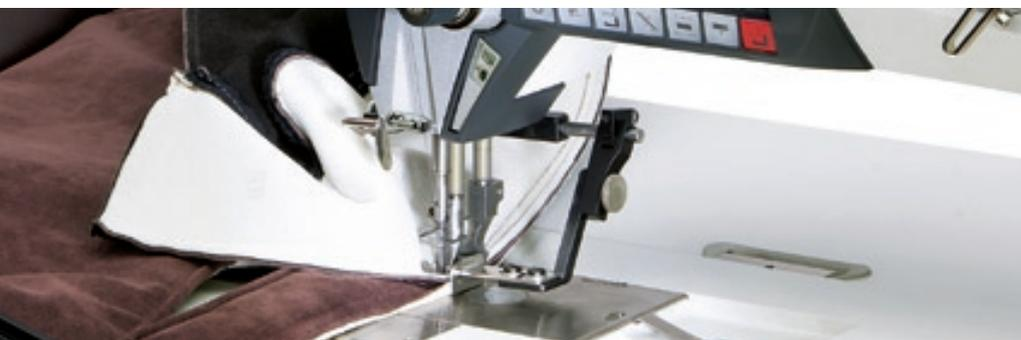
Piqûres d'assemblage/de jointage pour les travaux de pré-assemblage dans l'industrie automobile
