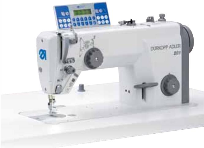
**281-140342-01:** Leistungsstarke Technik mit umfangreicher Standardausstattung wie Bedienfeld, Multifunktionstaster inkl. LED-Nähleuchte, elektromagnetische Füßchenlüftung, Näheinrichtung E2/20 für leichtes bis mittelschweres Material und neuartiges Handrad zum komfortablen Einstellen des Nähfußdrucks – ganz ohne Werkzeug.
