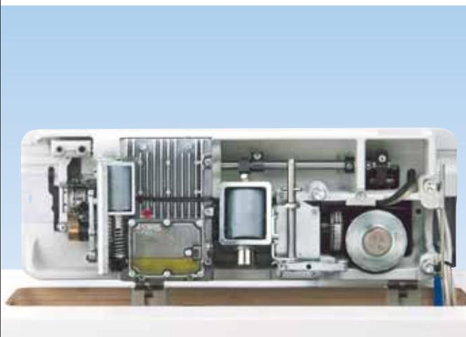
**281:** Wartungsfreundlicher, sauberer und übersichtlicher Aufbau der Maschinen-Unterseite.
