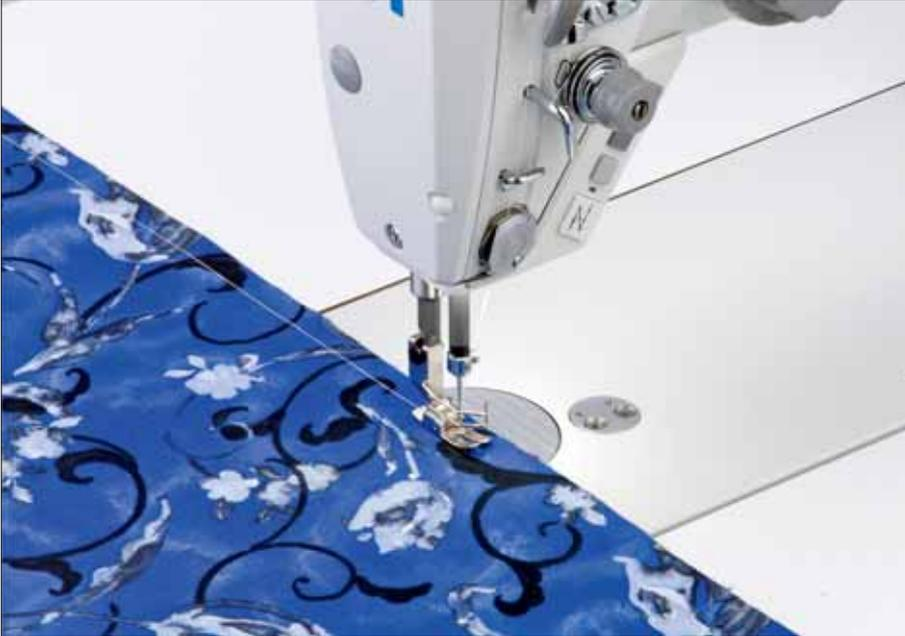
Der Premium Schnellnäher Klasse 281 ist serienmäßig mit der Näheinrichtung E2/20 für leichtes bis mittelschweres Nähgut und den universellen Einsatz in der Bekleidungsindustrie ausgestattet. Er steht für ein optimales Stichbild bei hoher Nähgeschwindigkeit, auch bei schwierigen Materialien.
