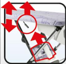
Régler la table dans sa position la plus élevée et retirer le réservoir d'eau froide
