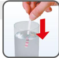
1. Plonger la bande de mesure dans l'eau pendant 1 seconde
