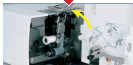
Enfilage rapide du boucleur inférieur
